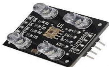
**Gambar 3. Sensor Warna TCS2300**
