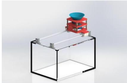
**Gambar 1** Desain 3D Alat Pemberi Pakan Otomatis
