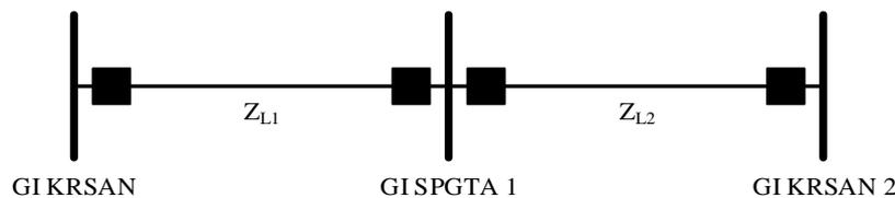
**Gambar 7. SUTT 150 kV Gardu Induk Keramasan - Gardu Induk Simpang Tiga 1 - Gardu Induk Keramasan 2**
