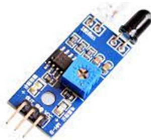
Gambar 3. Sensor Inframerah
