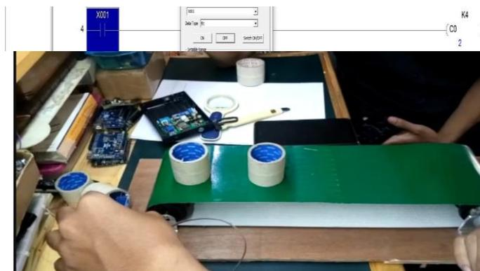
Gambar 9. Kondisi *Ladder Diagram* Dan Konveyor Ketika Barang 2 Melewati Sensor
