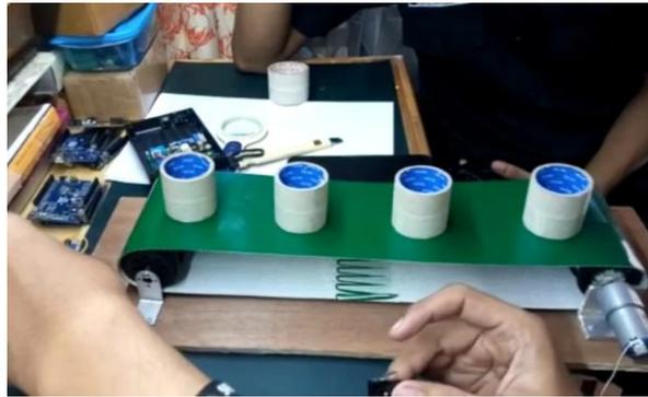
Gambar 7. Kondisi Konveyor Sebelum Dijalankan
