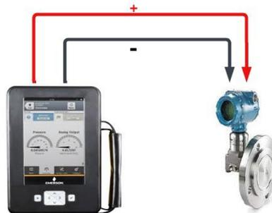
Gambar 2. Ilustrasi Rangkaian Untuk Proses Kalibrasi
