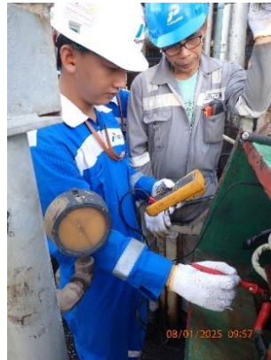
Gambar 4. Pengukuran tahanan isolasi motor induksi 3 fasa LCGO FC-PM-6A
