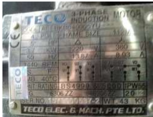
Gambar 5. Nameplate motor induksi tiga fasa Kompresor 9 SAP 100
