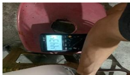
Gambar 8. Pengujian Limit Switch Ketika Tidak ada Gelas
