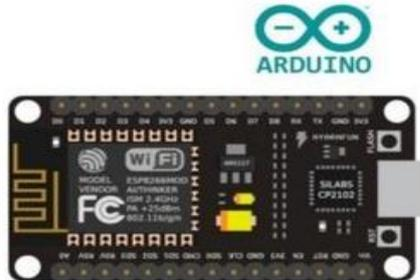
Gambar : NodeMCU ESP 8266
