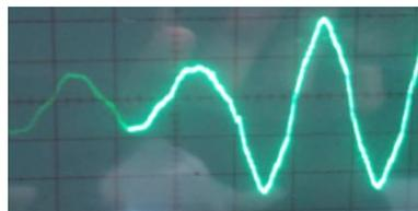
Gambar 13. Bentuk gelombang tanpa filter
