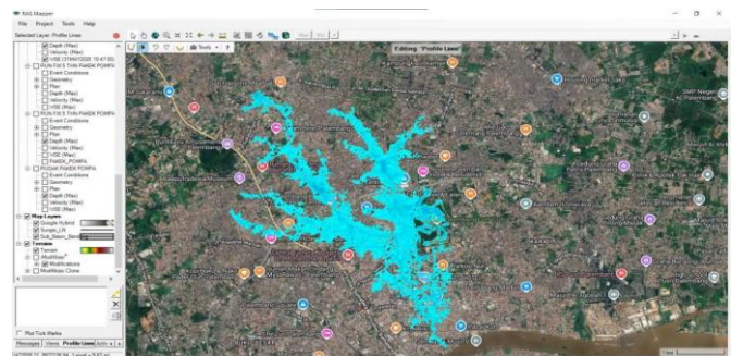
Gambar 7. Peta genangan banjir Sub DAS Bendung kala ulang 5 tahun hasil pemodelan HEC-RAS 7.0
